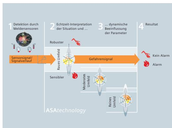
Die dynamische Parameteranpassung der **ASAtechnology** erhöht die Detektions- und Täuschungssicherheit.
