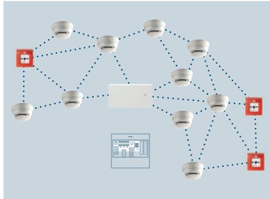
Informationen werden über mehrere Netzwerkknoten (Melder) zum Gateway weitergeleitet – das ermöglicht größere Netzwerke.
